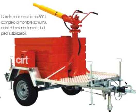
Carrello con serbatoio da 600 lt completo di monitor schiuma, dotati di impianto frenante, luci, piedi stabilizzatori.
